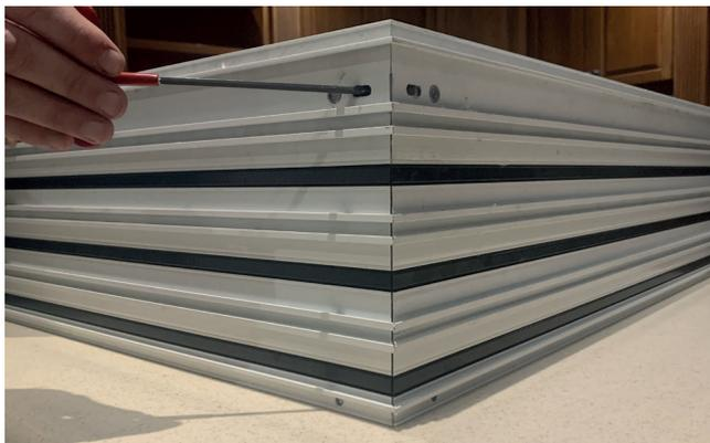
Utilice una llave Allen de 4 mm para apretar las chavetas de esquina ajustables en ambos lados del marco. Selle los orificios de unión de las esquinas con silicona 100%.
