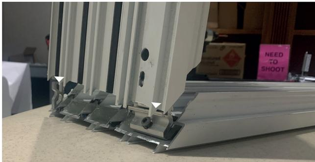
Asegúrese de que todas las cámaras del carril de la jamba estén selladas con silicona (consulte el paso E.1) y conecte el carril de la jamba deslizándolo por encima de las chavetas de esquina del carril del umbral. Repita el proceso para las dos jambas. Agregue sellador a la unión.
