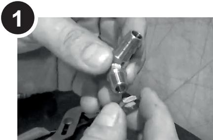
Enrosque la tuerca hexagonal de latón en la espiga de latón de la manguera y asegúrela firmemente.
